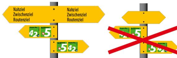
3. Wegweiser mit Routenfeldern werden in der Regel unterhalb des untersten Wegweisers montiert, sodass keine unnötigen «Zahnlücken» entstehen.
